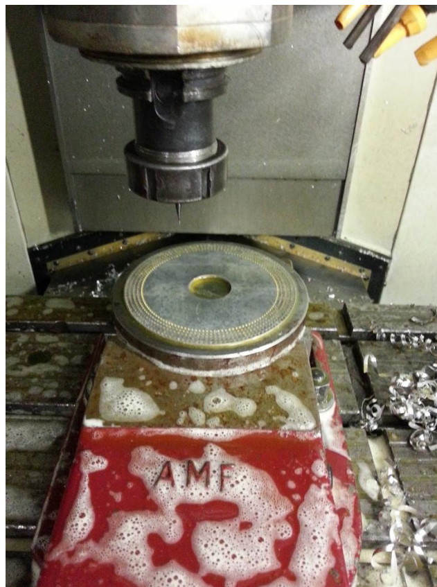
Fig. 4.4 - Fresadora CNC usinando o cloak de alumínio.
