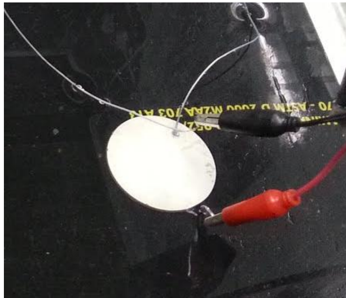
Fig. 4.8 - Cerâmica piezoelétrica utilizada nos ensaios.
